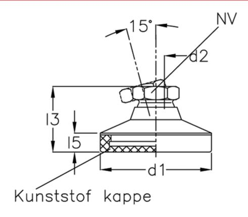
d1 = 50 d2 = 10 l3 = l5 = -NV = 15 Static load (N) = 11 t min = 10.5
